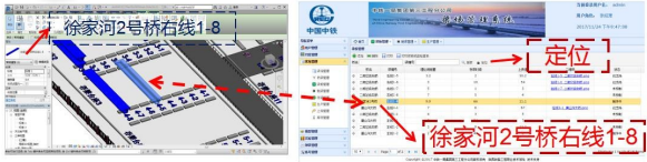
图 4 Web 子系统“定位”的梁在 BIM 模型中闪现
